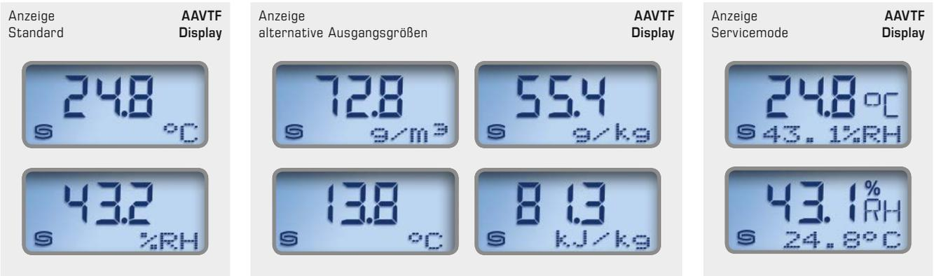
Standardmäßig wird im Display abwechselnd die **Ist-Temperatur** und die **Ist-Feuchte** (relative Feuchte) angezeigt. Hierbei wird in der erste Zeile der Wert und in der zweiten Zeile die entsprechende Einheit angezeigt:
